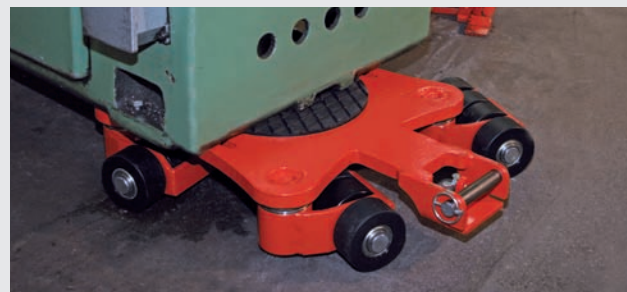
Le chariot rotatif JKB en action Draaibare transport cassette JKB in actie
